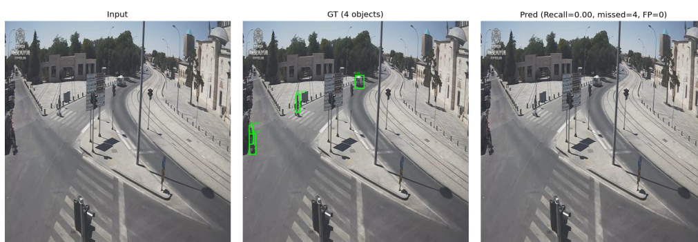
Hình 4.5: Failure case 1 (ba cột Input – Ground Truth – Prediction): ảnh tổng hợp với bốn đối tượng nhỏ, mô hình không phát hiện được bất kỳ đối tượng nào (recall = 0). Nguồn: tập val.
