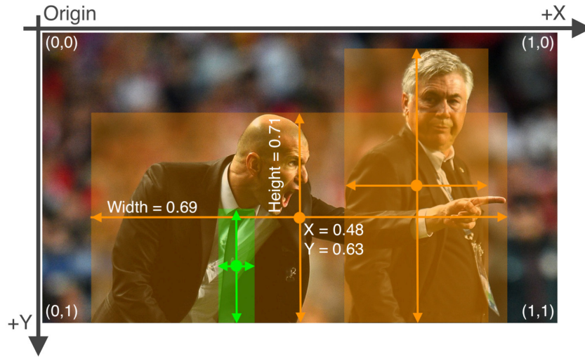
Hình 2.2: Hệ tọa độ YOLO-format: bounding box biểu diễn bằng (x_{center}, y_{center}, w, h) đã chuẩn hoá theo kích thước ảnh. Nguồn: tài liệu định dạng nhãn YOLO của Roboflow (Roboflow, n.d.).
