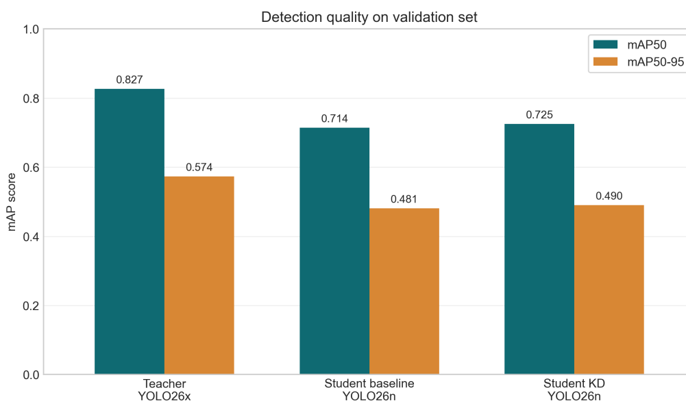
Hình 4.2: So sánh mAP50 và mAP50–95 giữa teacher (YOLO26x), student baseline (YOLO26n) và student KD (YOLO26n + Knowledge Distillation), đo bằng model.val() thống nhất trên 262 ảnh validation, imgsz = 640 , conf = 0,001 , iou = 0,7 . Số liệu chi tiết: Bảng 4.3.
